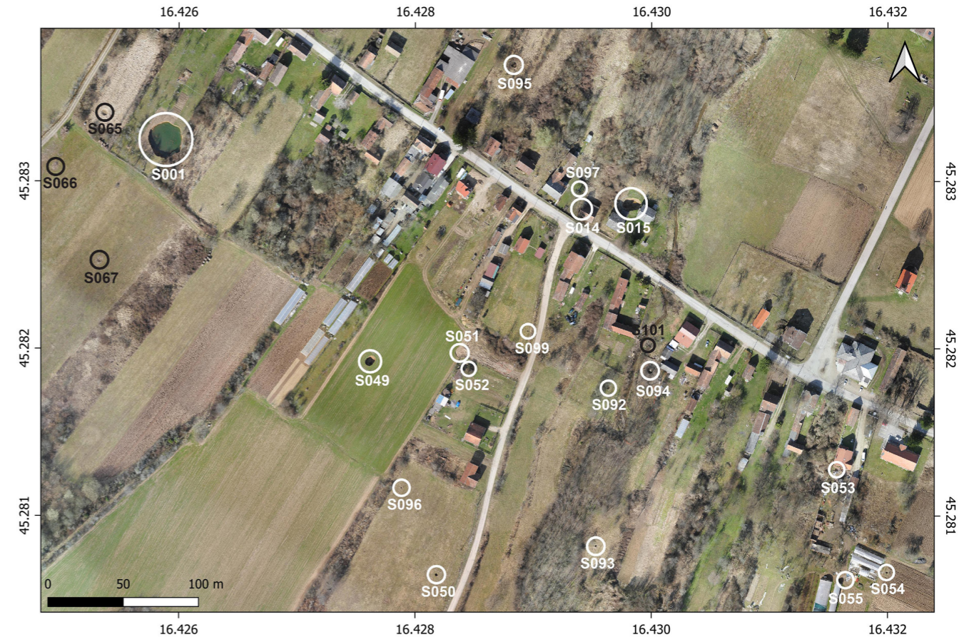
Slika 2. Dio ponikava s urušenim pokrovom u okolici sela Mečenčana (bijelo – nove ponikve otvorene nakon Petrinjskog potresa, crno – stare ponikve otvorene prije potresa u Petrinji; iz Tomac et al., 2021).
