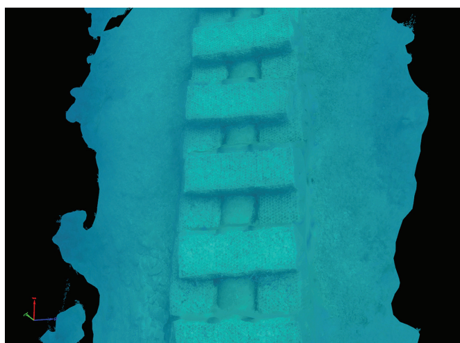
Slika 3. Dio SfM modela, gabionske zaštite.
